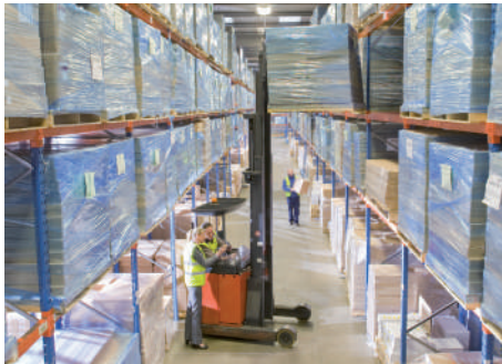
Carretillas que operan en instalaciones con estantes en altura y requieren mayor elevación
